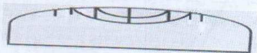
شکل (۵-۱) : نمایش تراز استوانه‌ای همراه با حباب آن
