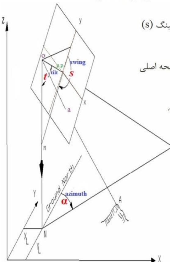
مجموعه سه دوران آزیمут ( $\alpha$ ), تیلت ( $t$ ) و سوئینگ ( $s$ ) نیز می‌توانند در توجیه دو سیستم به کار روند.
