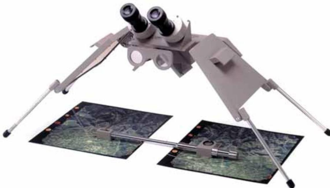
پس از قرار دادن پارالاکس بار بر روی دو عکس، با استفاده از پیچ ورنیه (یا پیچ کند یا پیچ میکرومتر) درجات دستگاه را بر روی درجات میانی قرار می‌دهیم. سپس پیچ تند دستگاه را باز کرده و شیشه سمت چپ را طوری تنظیم می‌کنیم که یک عارضه مشترک بر روی دو عکس حدوداً زیر فلوتینگ مارکهای (Floating Mark) شیشه‌های چپ و راست قرار گیرد. در این حالت پیچ حرکت تند را بسته و تا آخر پروژه به هیچ وجه آن را باز نمی‌کنیم.
