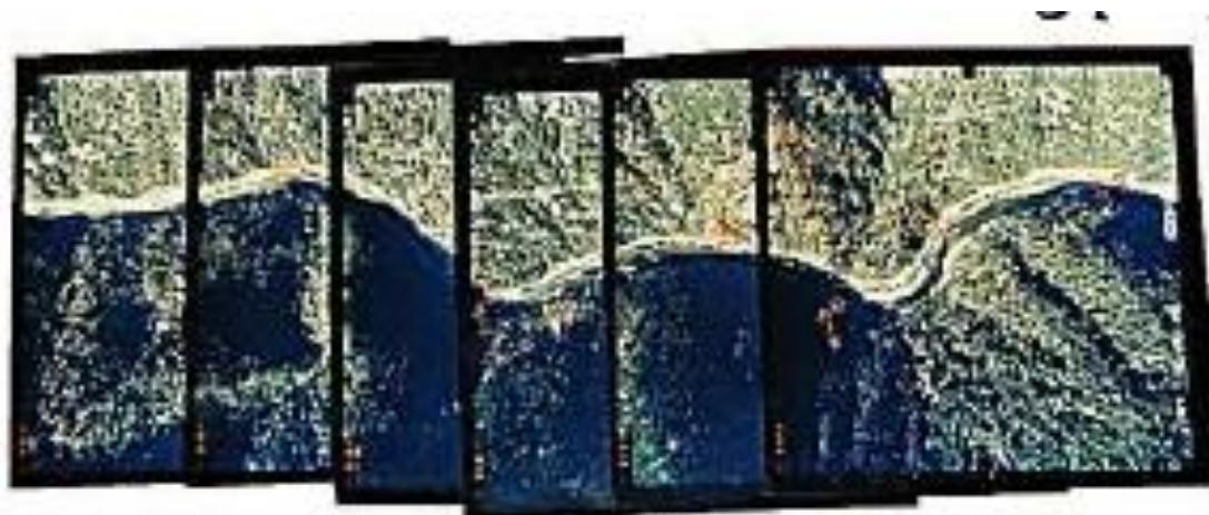
برای تشکیل موزاییک معمولاً قسمت‌های اضافی عکس بریده می‌شود و تنها قسمت وسط عکس که از خطای کمتری نیز برخوردار است، استفاده می‌شود. موزاییک بر اساس شماره نوار و شماره عکس‌ها تنظیم می‌شود. موزاییک بر دو نوع است:
