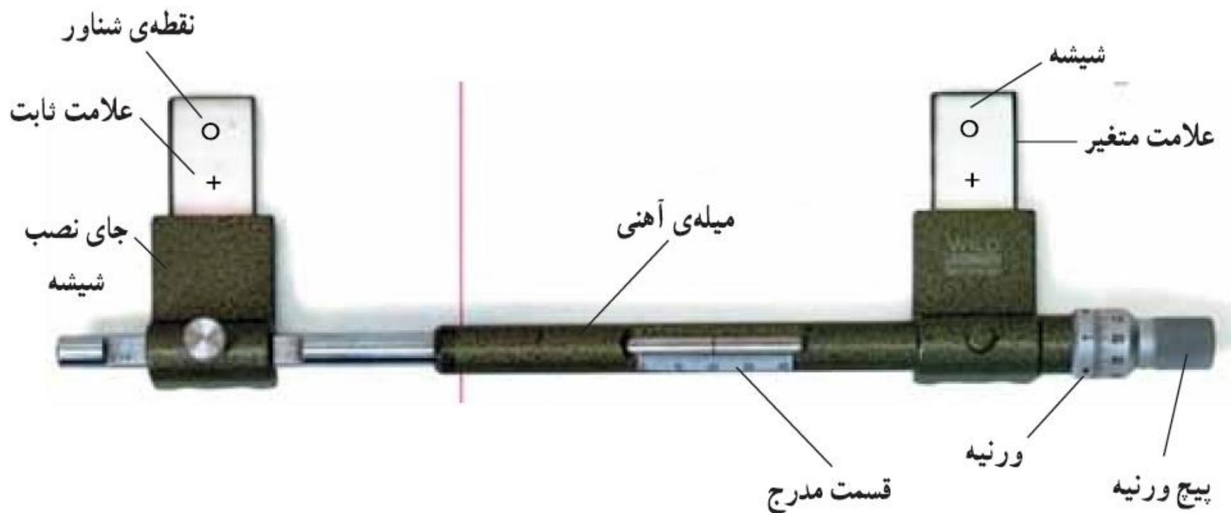
این دو قطعه شیشه که حامل نقطه‌ی شناور است به یک میله‌ی فلزی متصل می‌باشند. طول این میله به وسیله‌ی یک پیچ میکرومتری قابل تغییر است که با پیچاندن آن فاصله‌ی نقطه‌ی شناور سمت راست نسبت به نقطه‌ی شناور سمت چپ تغییر می‌کند. فاصله‌ی بین این دو با دقیقی در حد میکرون قرائت می‌شود. میکرومتر بدین گونه شماره‌گذاری شده است که، وقتی فاصله‌ی دو نقطه‌ی متناظر کم می‌شود اعداد قرائت شده بر روی پارالاکسبار بیشتر است و این قرائت بیشتر نشان دهنده‌ی ارتفاع بیشتر است.
