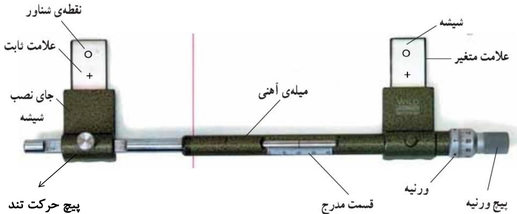
حال با پیچاندن پیچ میکرومتر علامت سمت راستی می‌تواند نسبت به علامت سمت چپ حرکت کند تا فاصله آن با علامت سمت چپ تغییر یابد. تغییر فاصله دو علامت در واقع میان تغییر پارالاکس نقاط یا به عبارت دیگر تغییر ارتفاع نقاط است. شکل اساس ساختمان و طرز کار پارالاکس بار را نشان می‌دهد. وقتی که علامت سمت چپ را ثابت نمودیم عدد ثابت پارالاکس بار یعنی  $C$  تعیین می‌شود.
