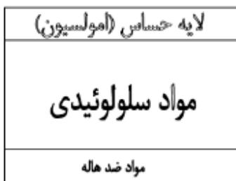
لایه حساس از جنس هالید نقره بوده و نسبت به به امواج الکترومغناطیس حساس می باشد . نور هنگام برخورد با لایه حساس موجب تجزیه آن و تشکیل پیوندهای ضعیف نقره و هالید می شود، در این صورت یک تصویر نهان بر روی فیلم نقش می بندد.
